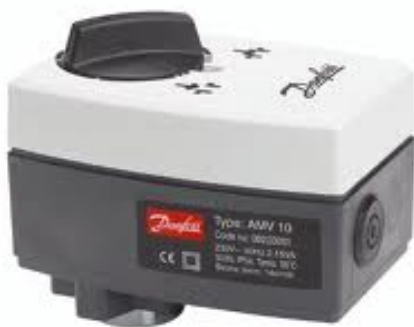
AMV 10 vožtuvams VMC (analoginis, 1 lūpa) 10 mm, gal. DN DN15, judėjimo greitis 7s.
