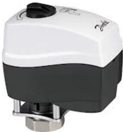
AMV 10 vožtuvams VMC (analoginis, 1 lūpa) 10 mm, gal. DN DN15, judėjimo greitis 7s.
